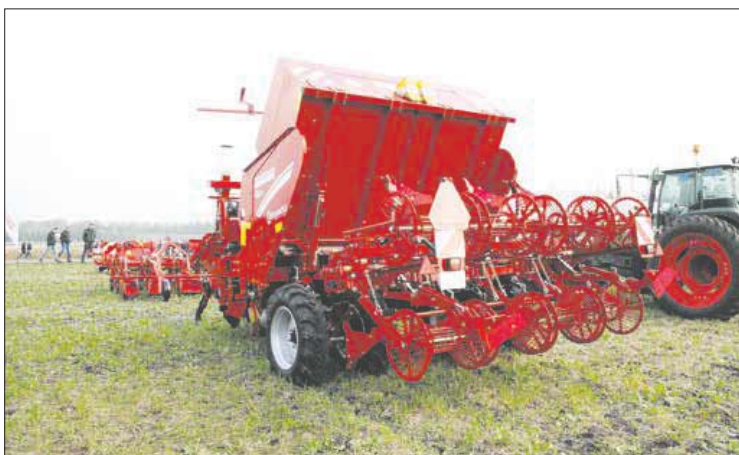
En af nyhederne ved gårsdagens kartoffeldag var denne Grimme GL-860 Compact 8-rækkede kartoffellægger præsenteret i udstilling. En klapbar kartoffellægger med gitteruller og udstyr til fosfor-placering.
