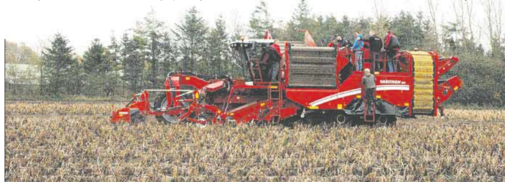
Mange benyttede lejligheden til at få en tur i marken med en af de mange kartoffeloptagere. Blandt andet denne Grimme Varitron 470 med hjul, der er en 4-rækket kartoffeloptager.
